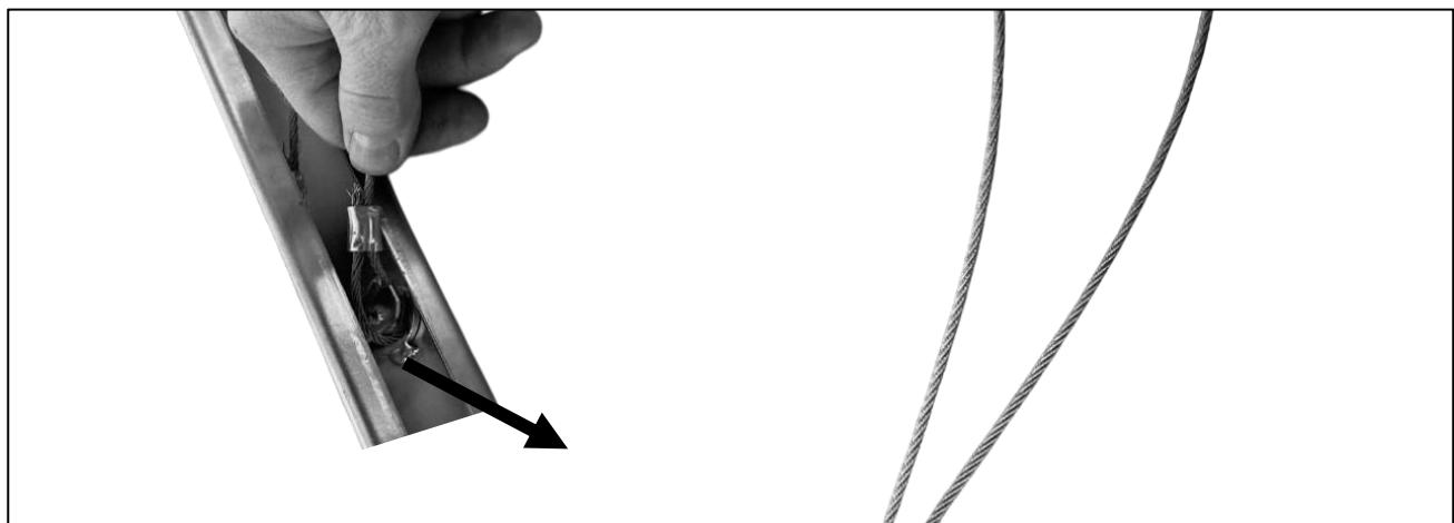
12. Das abgenutzte Kabel ist nun entfernt. Wiederholen Sie die vorherigen Schritte in umgekehrter Reihenfolge, um das neue Kabel zu installieren.
