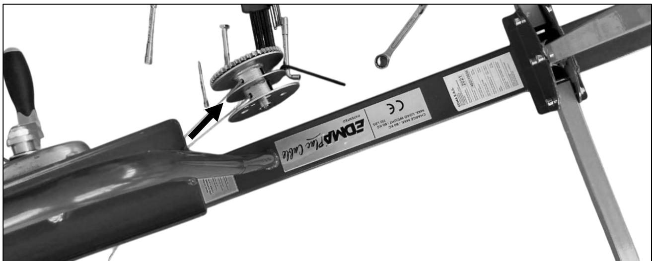
9. Poussez sur le câble à remplacer pour le faire ressortir par la grande ouverture sur le moyeu. Dévissez le serre-câble et retirez le câble usé du treuil.
