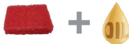
Lo scorrimento dei cuscinetti dell'impugnatura sulla guida, causerà gradualmente la rimozione del trattamento galvanico sulla pista di contatto. **Nessun problema**, è un effetto previsto e gestito dal **compensatore automatico integrato**. Utilizzando un feltro abrasivo tipo Scotch-Brite lubrificato con olio WD-40 / Svitol, **alla fine di ogni giornata lavorativa**, la pista si adatterà perfettamente ai cuscinetti dell'impugnatura e sarà protetta dall'ossidazione.
